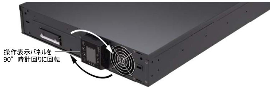
図 2-3 操作表示パネルの回転方法
