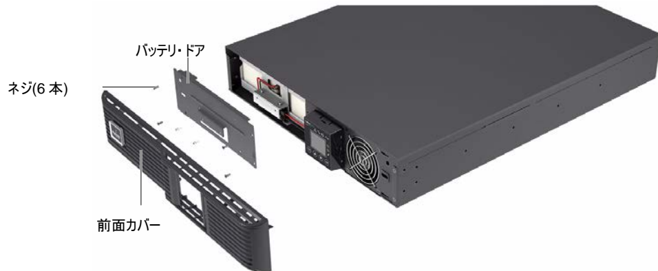
図 6-1 前面カバーとバッテリー・ドアを外す
